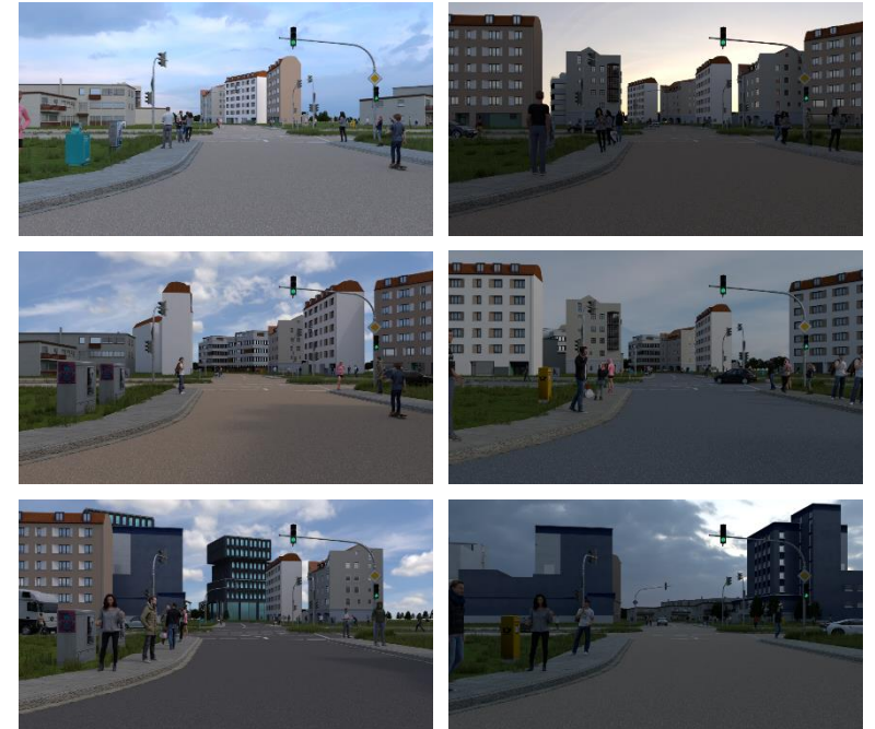
Synthetisch erzeugte Daten: Szenenvariationen bei gleichbleibender Sensorposition
