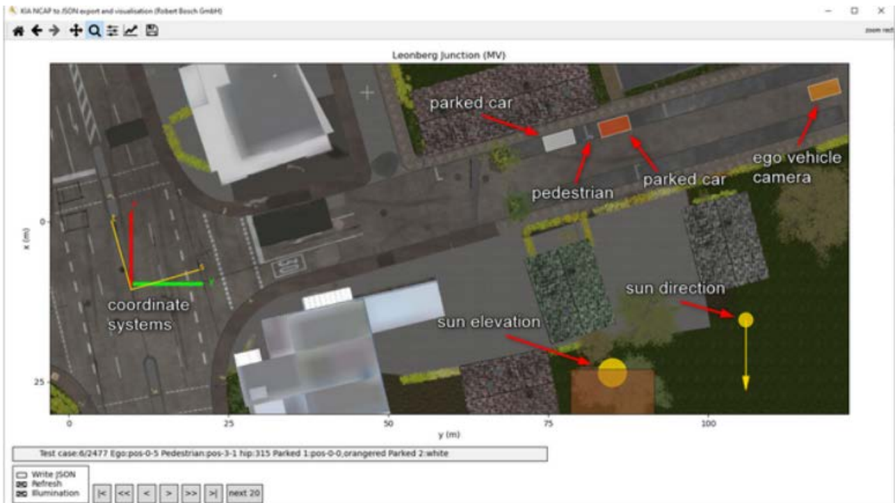
Abbildung 7.3: Tool zur Planung von parametrisierten Test-Szenarien Quelle: Bosch
